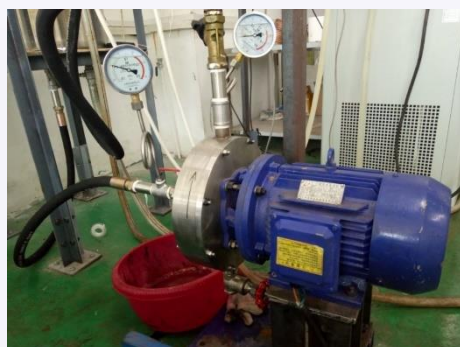
Схема и внешний вид кавитационного эмульгатора по а.с. № 1755906 СССР
