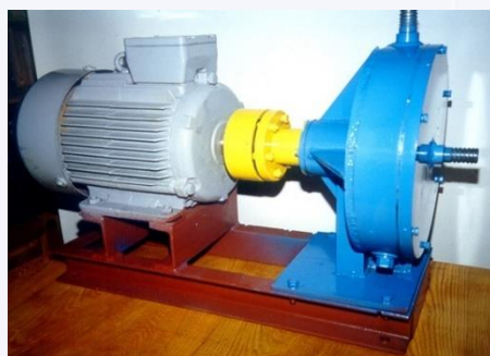
Схема и внешний вид кавитационного эмульгатора по а.с. № 1755906 СССР
