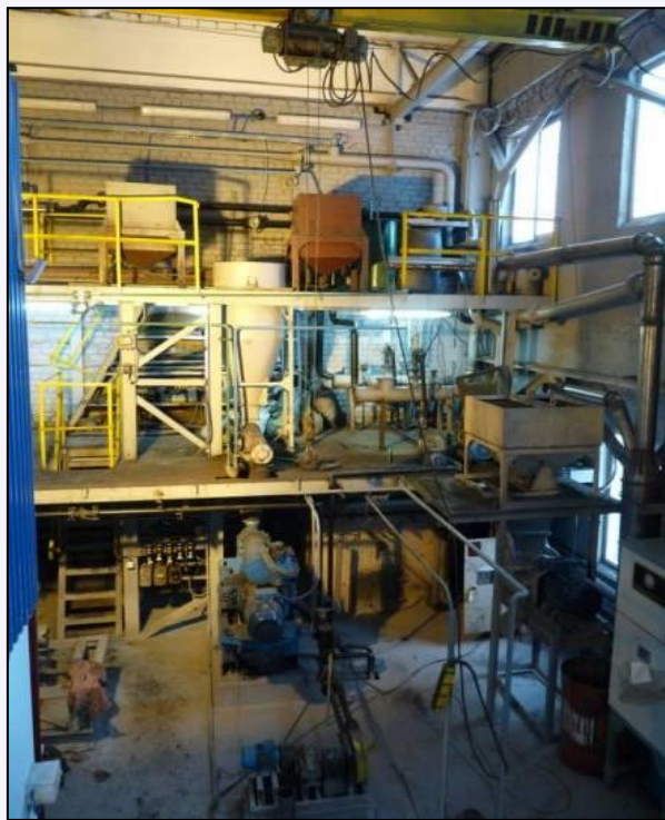
Fig. 2. Блок приготовления водоугольного топлива экспериментальной установки, Сибирский государственный индустриальный университет, Россия.
