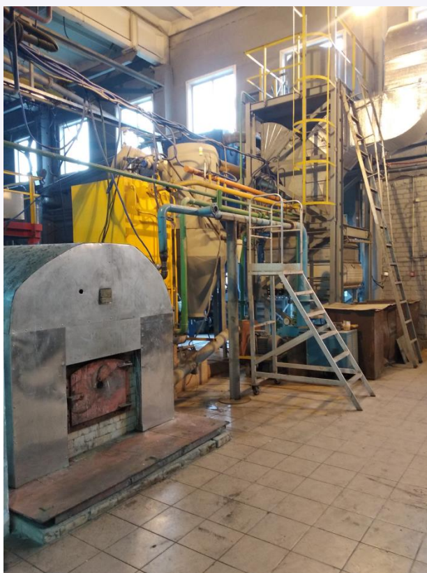
Fig. 2. Блок приготовления водоугольного топлива экспериментальной установки, Сибирский государственный индустриальный университет, Россия.
