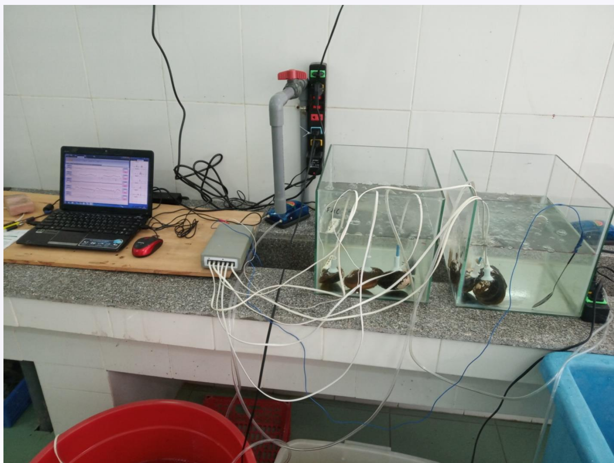
Рис.1. Лабораторная установка для контроля кардиоритмов моллюсков
