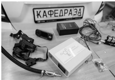
Система водородного топлива состоит из нескольких устройств. Сам генератор водорода не является полной заменой бензинового двигателя, он, расщепляя воду на кислород и водород внутри автомобиля, по трубопроводу передает заряд водорода в камеру сгорания двигателя.
