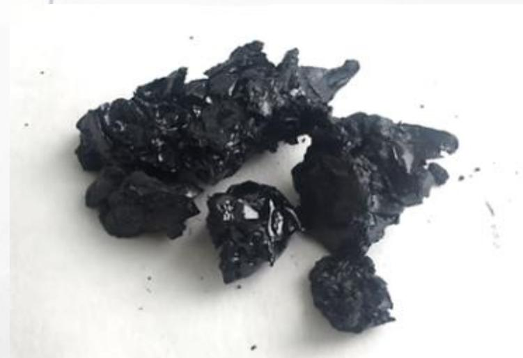
На данный момент проведены исследования по термическому растворению углей в антраценовом масле. Определены оптимальные параметры проведения процесса, исследовано качество полученных продуктов. Показана возможность получения напрямую из угля, минуя высокотемпературный процесс коксования, сырья для производства связующего материала с пониженным содержанием бенз(а)пирена.
