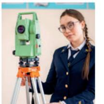
6. Геодезический прибор для измерения горизонтальных и вертикальных углов, расстояний и превышений между точками на земной поверхности.
