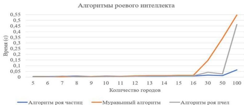
Рис.2. Зависимость времени расчета от размерности решаемой задачи для роевых алгоритмов
