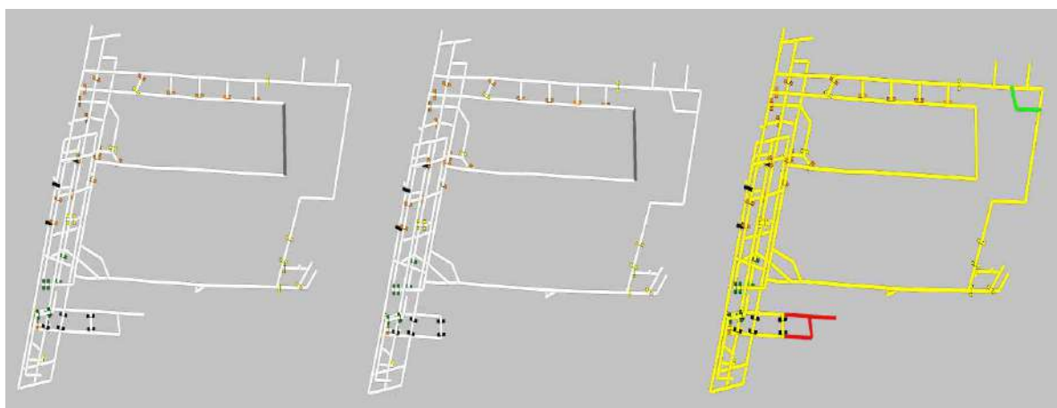
Рисунок 2 – Пример результата сравнения двух моделей топологий шахт: слева - базовая модель, по центру – модель с изменениями, справа – результат сравнения. Красным цветом выделены исчезнувшие ветви, зеленым – появившиеся, желтым - аналогичные
