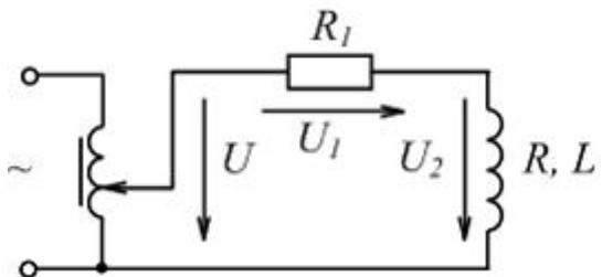
Для определения параметров  $R$  и  $L$  индуктивной катушки ее соединили последовательно с
